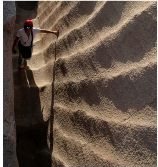
Mısır'da granit ocağında, taş çekiçler ve ısıl genleşmeyle (ateş yakarak) açılmış kanallar
